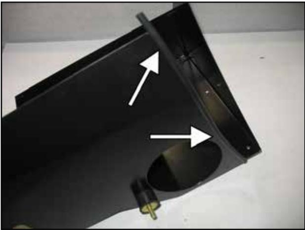
f. Install the edge trim on the edge shown and cut off excess.
