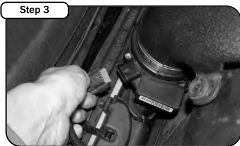
Step 3 Remove MAF sensor plug.
