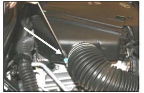
INSTALL RUBBER WASHERS & PLASTIC PLUG AIR BOX COVER WEEP HOLES AS SHOWN IN
