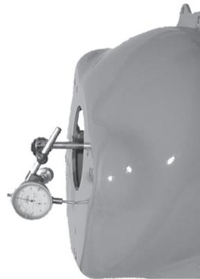
NEXT, THE BELLHOUSING FACE SHOULD BE CHECKED FOR PARALLELISM TO THE BACK OF THE BLOCK. INSTALL THE INDICATOR (AS SHOWN ABOVE). ROTATE THE CRANKSHAFT AND MARK DOWN THE READINGS (BE SURE TO PUSH THE CRANKSHAFT AGAINST THRUST BEARING FOR ACCURATE MEASUREMENT). THE MAXIMUM OUT OF PARALLELISM IS .002"
