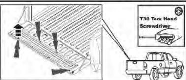
Localiser et enlever les vis existantes de tête de torx localisées sur l'hayon de véhicule utilisant un tournevis de tête de torx de T30 comme indiqué.
