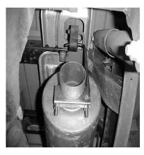
INSTALL THE REAR MUFFLER HANGER #G. THE VERTICAL ROD OF THE HANGER WILL BE POSITIONED ON THE PASSENGER SIDE OF THE MUFFLER OUTLET. DO NOT TIGHTEN.
