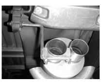
SLIP MUFFLER # B ONTO
