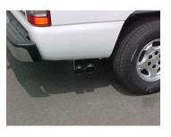
MAKE SURE YOU HAVE A 1" CLEARANCE ON ALL RUBBER BRAKE LINES, SHOCK BOOTS, TIRE, FUEL LINES, ETC.
