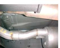
NEXT INSTALL MUFFLER #C. SLIDE IT ONTO HEADPIPE 1-1/2" TO 2". INLET OF MUFFLER SHOULD FACE TOWARDS THE MOTOR. INSTALL REAR MUFFLER HANGER # I INTO RUBBER GROMMET LOCATED JUST ABOVE THE DRIVERS SIDE OUTLET OF THE MUFFLER. SLIDE CLAMP ONTO MUFFLER OUTLET. INLET OF MUFFLER IS LOOKING INTO THE LOUVERS. DO NOT TIGHTEN.
