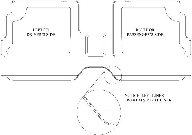
TO EASE INSTALLATION OF LINERS, MOVE BOTH FRONT SEATS TO THEIR MOST FORWARD POSITION. INSTALL DRIVER'S SIDE LINER FIRST AS THE PASSENGER SIDE LINER OVERLAPS THE PORTION OF THE DRIVER'S SIDE LINER THAT COVERS THE TRANSMISSION TUNNEL. ONCE THE LINERS ARE INSTALLED, REPOSITION SEATS AS DESIRED.
