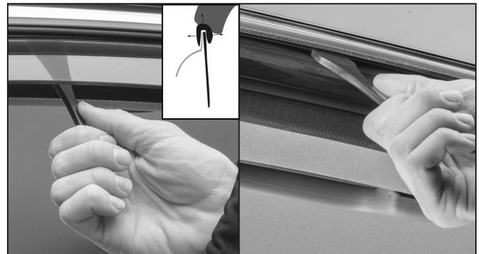
**8** Carefully run seating tool between deflector and window seal to seal the deflector. *Pase cuidadosamente la herramienta de ajuste entre el deflector y la junta de estanqueidad de la ventanilla para sellar el deflector.*
