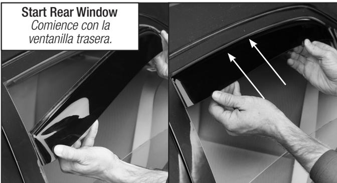
**7** Be sure to remove adhesive backing before installation (if supplied). Slide upward into place, then gently pull outward to set the deflector. *Asegúrese de quitar el reverso adhesivo antes de la instalación (en caso de que exista). Deslice hacia arriba y colóquelo en su lugar. Luego, tire suavemente hacia afuera para fijar el deflector.*
