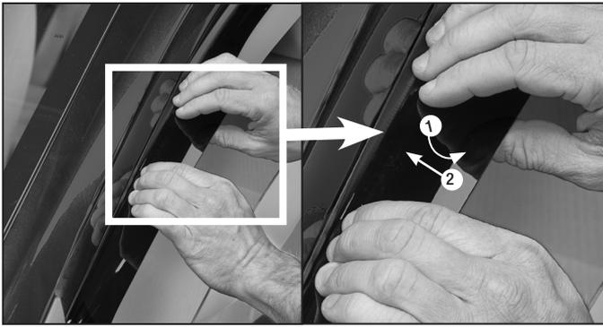
**5** Pull down and tuck in working from front to back. *Tire hacia abajo y póngase a trabajar desde el frente hacia atrás.*
