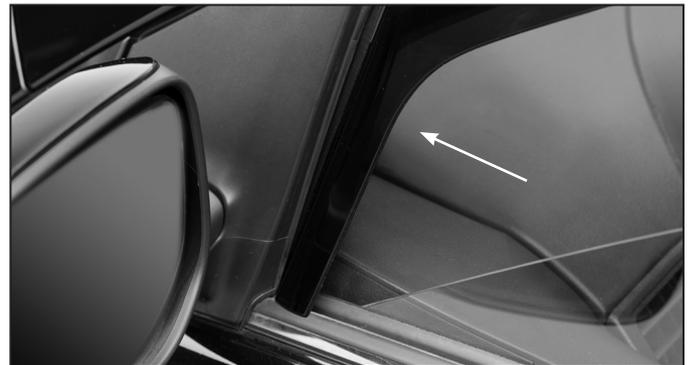
**2** Slide forward, into window channel. Ensure edge rests on top of the outer window sill! *Asegúrese de que el borde quede apoyado en la parte superior de la solera de la puerta exterior.*
