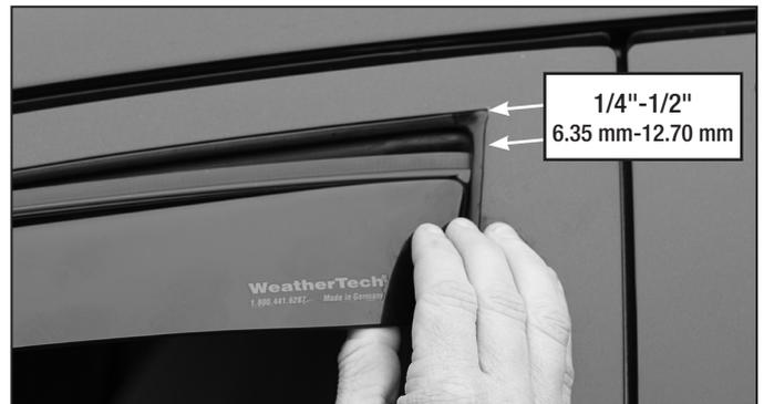
**4** Insert rear edge leaving a gap at the top. *Inserte el borde trasero dejando un espacio en la parte superior.*
