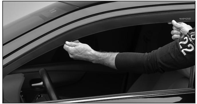
**6** Carefully pull outward on the deflector. *Tire cuidadosamente el deflector hacia afuera.*
