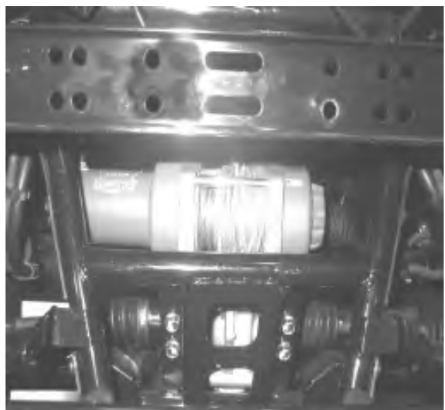
Figure 2, Placez le treuil en position
