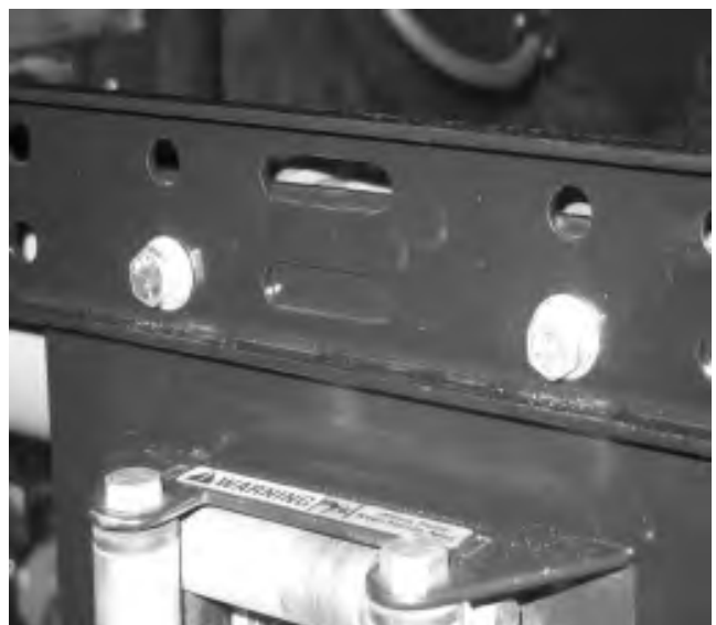
Figure 5, Fixez le treuil et la plaque de montage
