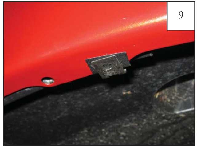
9 Install Clip (CL1-0022) over Tab (MT1-0014).
