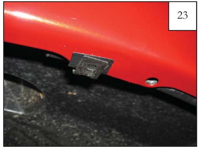
Install clip (SW1-0022) over 1"x1.5" Black Tab.
