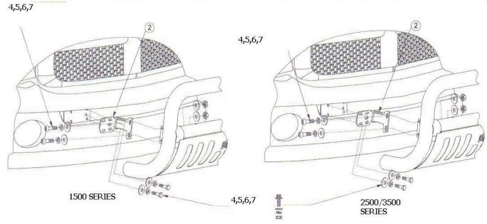
FIGURE 3-INSTALLATION VIEW OF PASSENGER SIDE, DRIVER SIDE OPPOSITE
