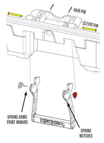
**HELPFUL TIP:** MAKE SURE SPRINGS HAVE THE LONG ARM HORIZONTAL AND SHORT LEG VERTICAL BEFORE INSERTING HANDLE
