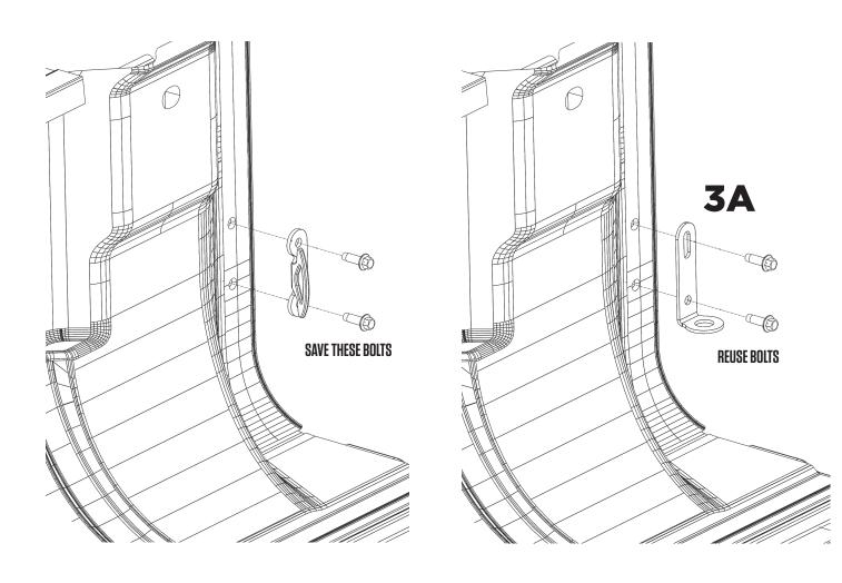
FACTORY SUPER DUTY TIE-DOWN BRACKETS DECKED TIE-DOWN BRACKETS
