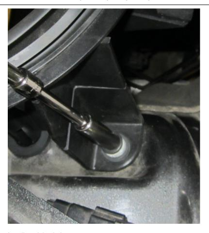
Install retaining bolt.
