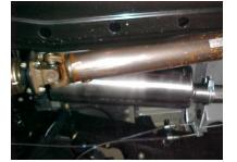
INSTALL THE MUFFLER ONTO THE HEADPIPE 1" TO 2". THE INLET OF THE MUFFLER WILL HAVE THE INSIDE LOUVERS FACING FORWARD. USE CLAMP #E TO SECURE MUFFLER TO THE HEADPIPE. OUTLET SHOULD BE AT THE 7 O'CLOCK POSISTION. DO NOT TIGHTEN.
