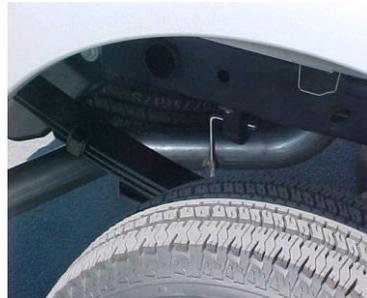
INSTALL MUFFLER # B ONTO HEADPIPE 1 1/2" TO 2". USE CLAMP # E TO SECURE MUFFLER TO HEADPIPE. DO NOT TIGHTEN. USE A JACK STAND TO HOLD UP THE MUFFLER. MUFFLER INLET IS LOOKING INTO THE LOUVERS. OUTLET SHOULD BE AT THE 12 O'CLOCK POSITION.
