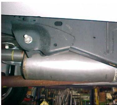
INSTALL MUFFLER # B ONTO HEADPIPE 1 1/2" TO 2". USE CLAMP # E TO SECURE MUFFLER TO HEADPIPE. DO NOT TIGHTEN. USE A JACK STAND TO HOLD UP THE MUFFLER. MUFFLER INLET IS LOOKING INTO THE LOUVERS. OUTLET SHOULD BE AT THE 10 O'CLOCK POSITION.
