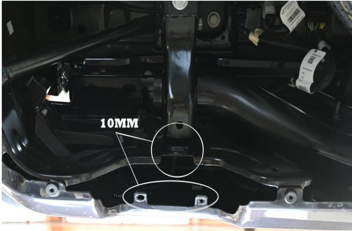
**1)** FIRST, REMOVE **3** BOLTS HOLDING BOTH DRIVER AND PASSENGER SIDE FACTORY TIPS ON. THERE IS **2** LOCATED ON THE INSIDE OF THE BUMPER AND **1** LOCATED DIRECTLY ABOVE THE TIP.
