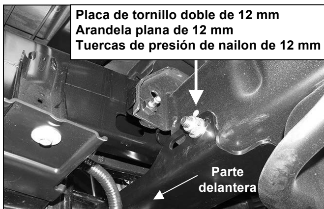
(Fig. 7B) Instalación de soporte del pasajero en posición "hacia adelante" para mover la parrilla delantera fuera del parachoques
