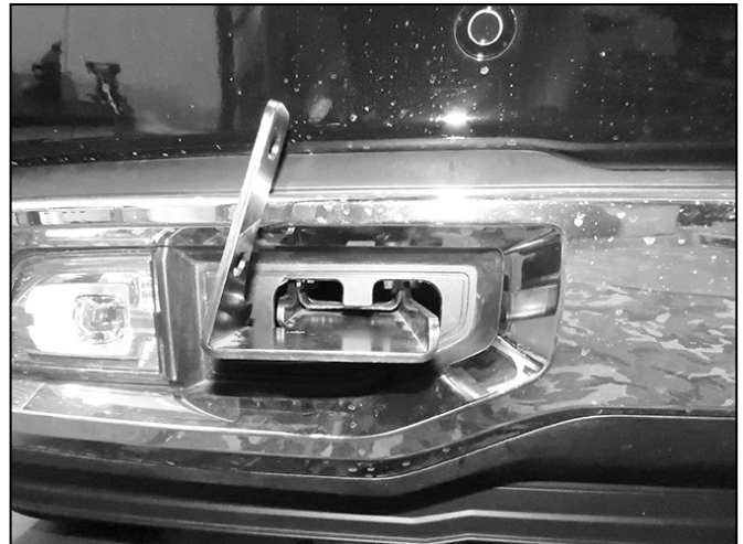
(Fig. 11) Soporte del lado del pasajero/derecho instalado
