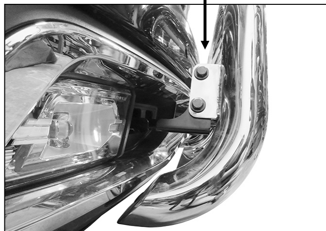
(Fig. 13) Instalación completa del lado del pasajero/derecho
