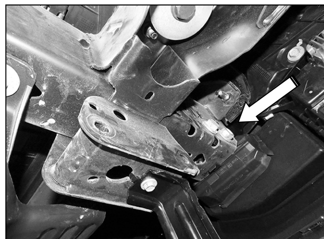
(figure 3) Boulons de montage extérieurs côté passager/droit pour crochet de remorquage, illustrés de l'arrière du pare-chocs
