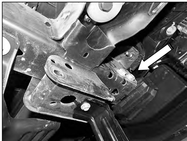
(Fig. 3) Pernos de montaje exterior del lado del pasajero/derecho para el gancho de remolque representado desde atrás del parachoques
