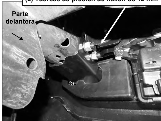
(Fig. 8) Soporte lateral exterior del lado del pasajero/derecho con placa de tornillo doble ilustrada desde atrás del parachoques
