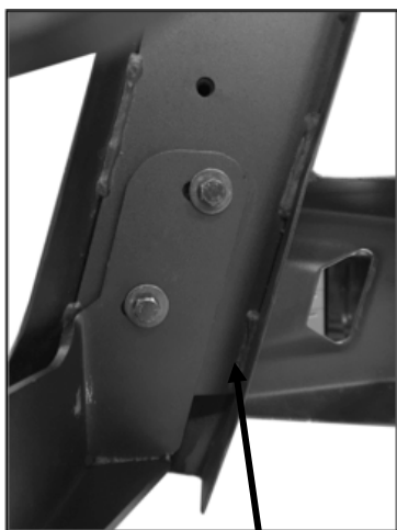
(figure 10) Support intérieur côté passager/droit avec plaque à simple boulon, illustré de l'arrière du pare-chocs
