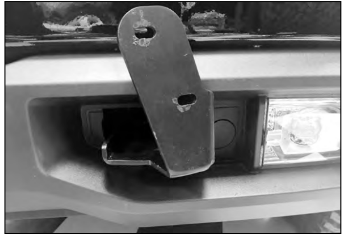
(Fig. 11) Soporte del lado del pasajero/derecho instalado
