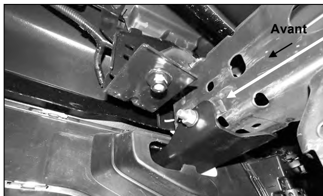
(figure 10) Support intérieur côté passager/droit avec plaque à simple boulon, illustré de l'arrière du pare-chocs
