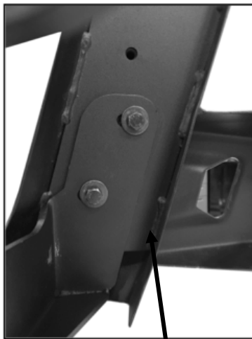
(Fig. 10) Soporte lateral interior del lado del pasajero/derecho con placa de un solo tornillo ilustrada desde atrás del parachoques
