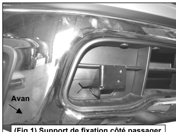
(Fig 1) Support de fixation côté passager inséré à travers la protection
