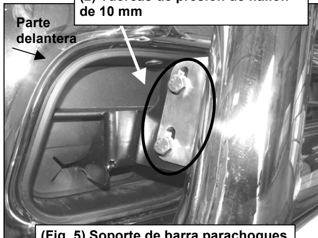
(Fig. 5) Soporte de barra parachoques del lado del pasajero unido a la barra parachoques
