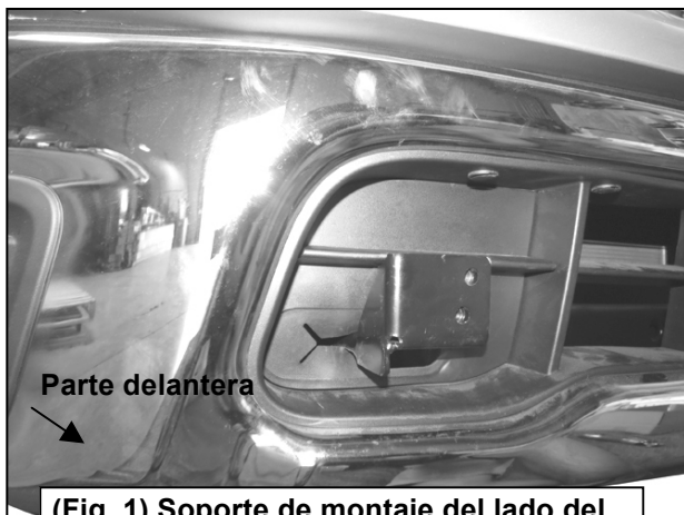
(Fig. 1) Soporte de montaje del lado del pasajero insertado a través de la tapa
