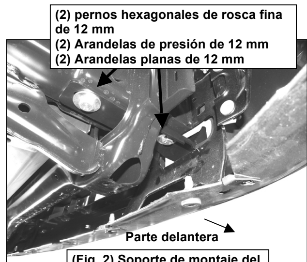
(Fig. 2) Soporte de montaje del lado derecho/del lado del pasajero instalado
