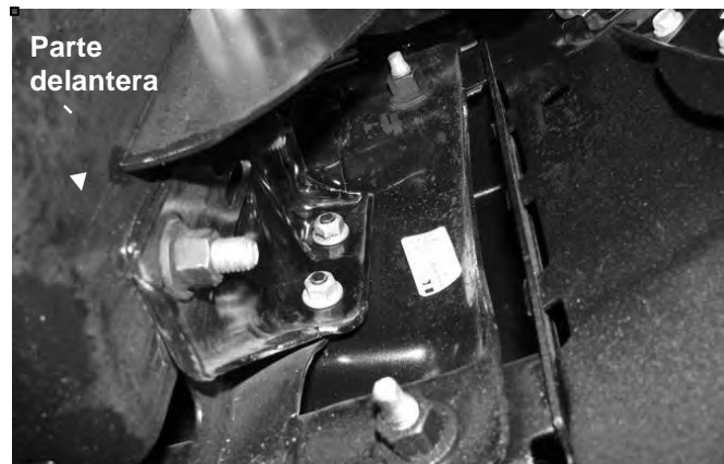
(Fig. 2) Componentes de montaje del enganche del remolque desde la parte posterior del lado derecho/del pasajero del paragolpes
