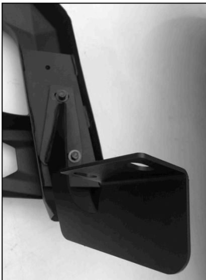
(Fig. 7) Fije los soportes de la parrilla delantera a los soportes del bastidor con el conjunto de pernos M8. (Para fines ilustrativos, se muestra fuera del vehículo)
