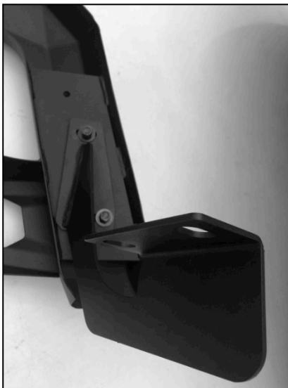
(Fig. 7) Fixer le pare-buffle au support de fixation à l'aide de l'ensemble de boulons M8 (4) (Figure 7). (le véhicule est présenté à titre d'illustration)
