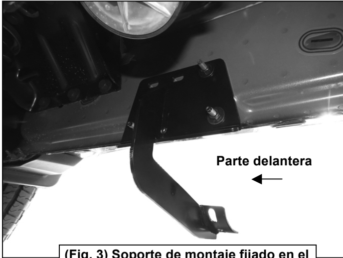
(Fig. 3) Soporte de montaje fijado en el lado delantero derecho/del pasajero
