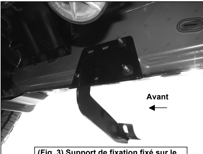
(Fig. 3) Support de fixation fixé sur le côté avant droit/passager
