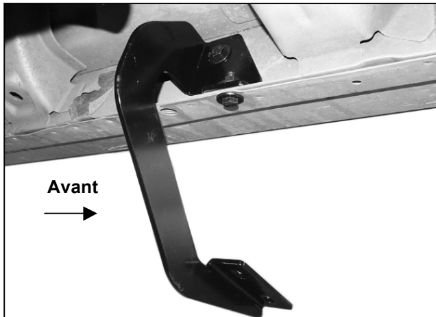
(Fig. 9) Installation du support central gauche/côté conducteur
