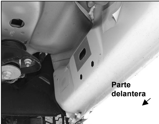
(Fig. 1) Ubicación de montaje delantero del lado del pasajero en modelos desde 2009 hasta mediados de 2015 (sin orificios de fábrica en los modelos 2009-2012 con soldadura por pellizco)
