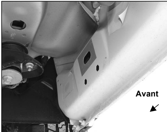
(Fig. 1) emplacement de montage avant passager 2009 à mi-2015 (pas de trous d'usine dans les modèles de joints de soudure 2009 à 2012)
