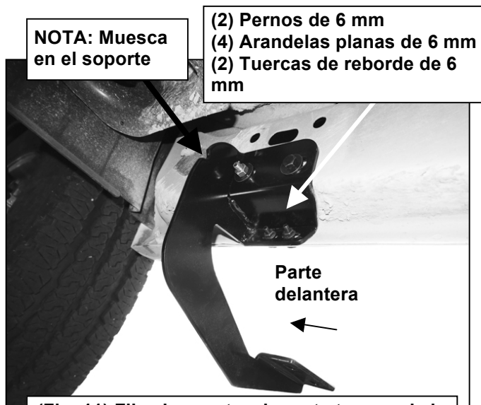
(Fig. 11) Fije el soporte a la parte trasera de la soldadura por pellizco (modelos con orificios de fábrica únicamente en soldadura por pellizco).
