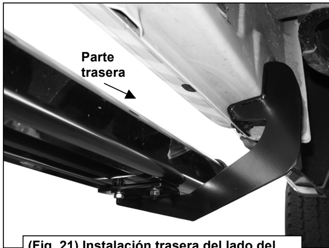
(Fig. 21) Instalación trasera del lado del pasajero
