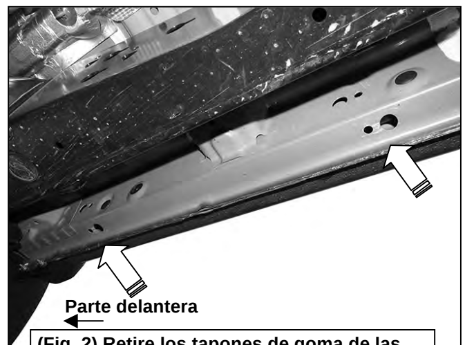
(Fig. 2) Retire los tapones de goma de las ubicaciones de montaje delantera y central (flechas)
