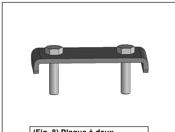
(Fig. 8) Plaque à deux boulons de 8 mm
