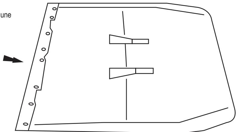
Poser la traverse au-dessus du tissu à replier vers l'intérieur et fixer avec des attaches comme illustré.
