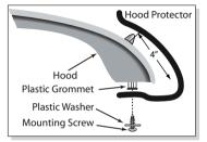
KIT CONTAINS: HOOD PROTECTOR 4 MOUNTING SCREWS 4 SHOULDER WASHERS 4 PLASTIC INSERTS 1 RUBBER BUMP-ON\* TOOLS NEEDED: PHILLIPS SCREWDRIVER
