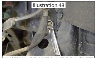
INSTALL BRAKE LINE BRACKET
