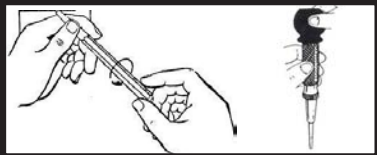
Figura 5: Durante la centratura della piastra di fissaggio, allineare i bulloni a U frontali e contrassegnare la piastra di slittamento per la foratura dei fori passanti.
