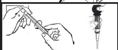
Figura 5: Ao centrar a chapa dorsal de fixação, alinhe com os grampos parafusos em U dianteiros e marque a chapa protetora onde fará a perfuração.
